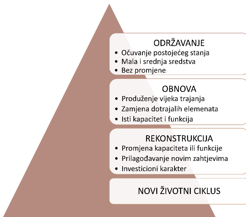
Slika 7-3. Šematski prikaz odnosa održavanja, obnove i rekonstrukcije u životnom ciklusu saobraćajne infrastrukture
